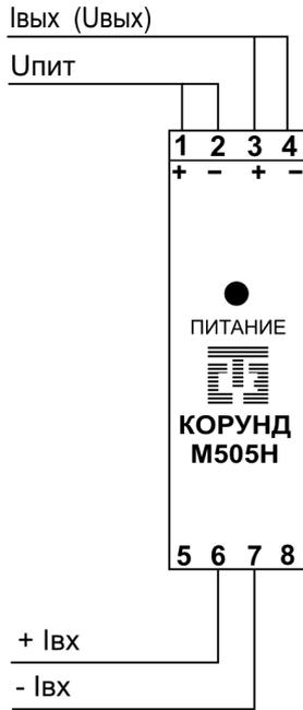
Подключение трехпроводных датчиков
