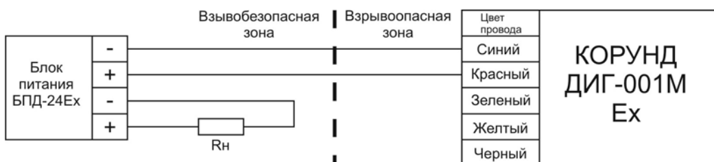
Рис.В5. Схема соединений датчиков КОРУНД искробезопасного исполнения с блоком питания, имеющим встроенный барьер искрозащиты.
