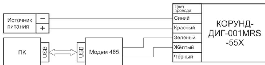
Рис.Б9. Схема соединения датчиков КОРУНД-ДИГ-001MRS-55Х с выходным сигналом RS-485 Modbus RTU в монорежиме
