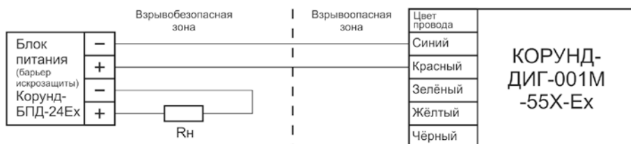
Рис.Б6. Схема соединений датчиков КОРУНД искробезопасного исполнения с блоком питания, имеющим встроенный барьер искрозащиты.
